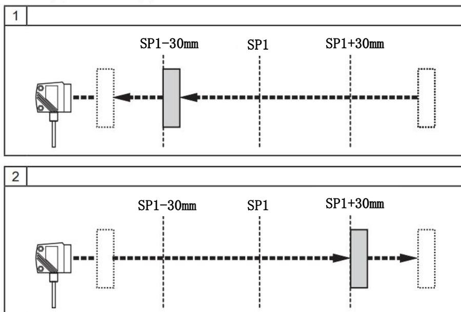
选择输出功能 [Hnc] 时，将转换设置点和复位点。物体接近时，输出功能将关闭。物体移开时，输出
