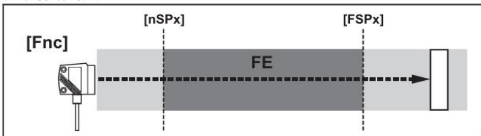
[nSPx]=“近”开关点; [FSPx]=“远”开关点; FE=窗口
