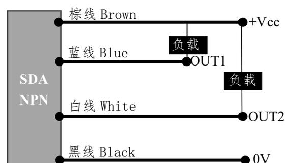
注释：OUT1 和 OUT2，负载允许最大电流 100mA；
