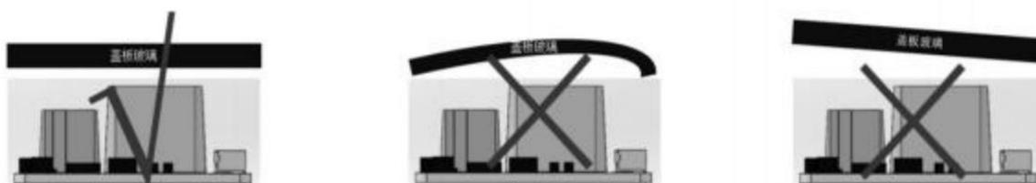
图 4 遮光片的安装示意图
